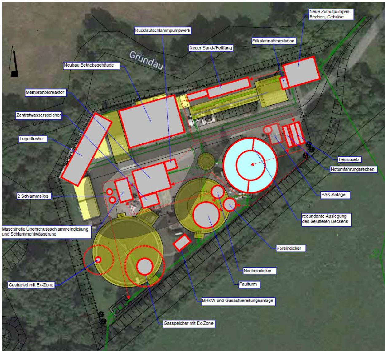
Abbildung 14: Endausbau (Variante 1 "Bestandsausbau") (siehe Anlage 2)
