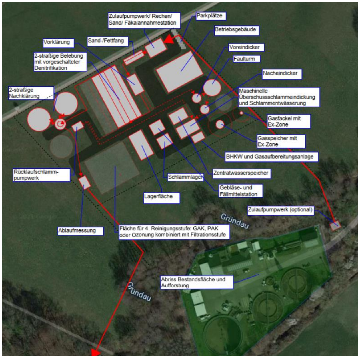
Abbildung 20: Endausbau (Variante 3: „Neubau auf der Erweiterungsfläche“) (siehe Anlage 2)
