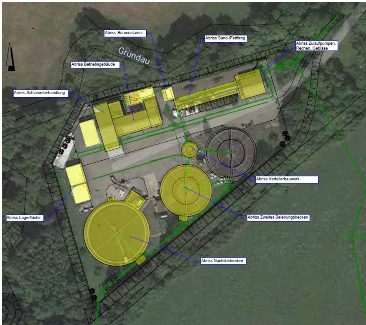
Abbildung 13: Abrissmaßnahmen (Variante 1 „Bestandsausbau“) (siehe Anlage 2)
