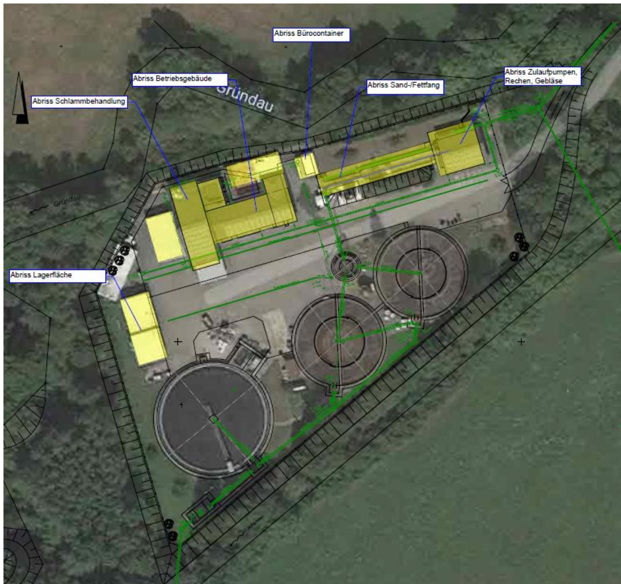
Abbildung 16: Abrissmaßnahmen (Variante 2 "Bestandsausbau und Erweiterung") (siehe Anlage 2)
