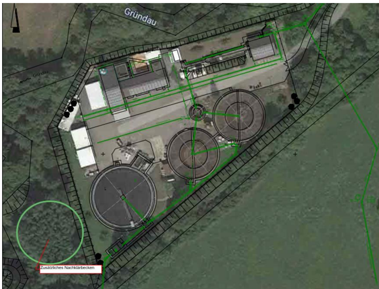
Abbildung 9: Lösungsansatz eines 2. Nachklärbeckens (plakative Darstellung)
